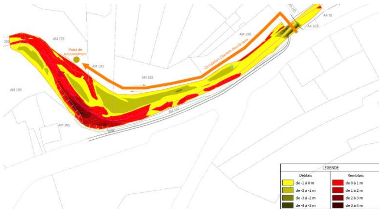
Figure 11 : Plan de circulation et plan de terrassement du chantier
